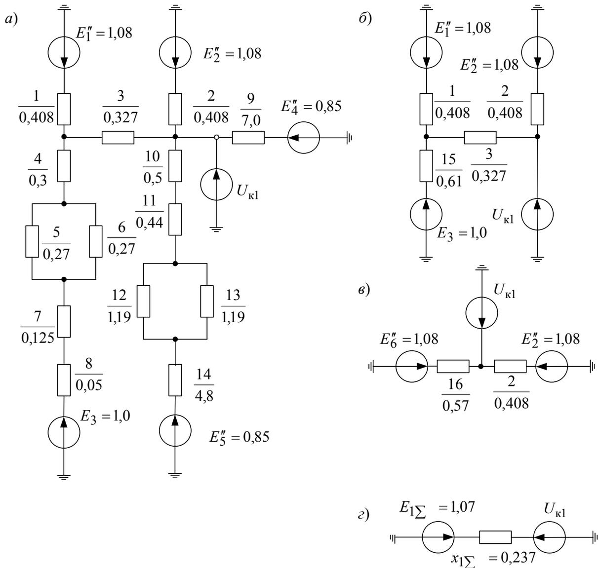
Рис. 7. Схемы замещения прямой последовательности
