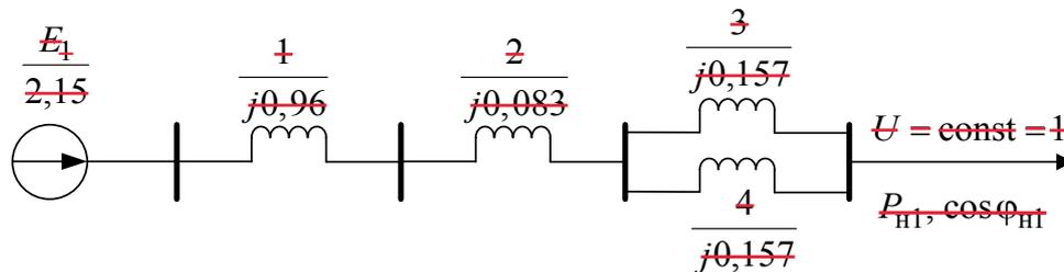
~~Рис. 15. Расчетная схема замещения~~
