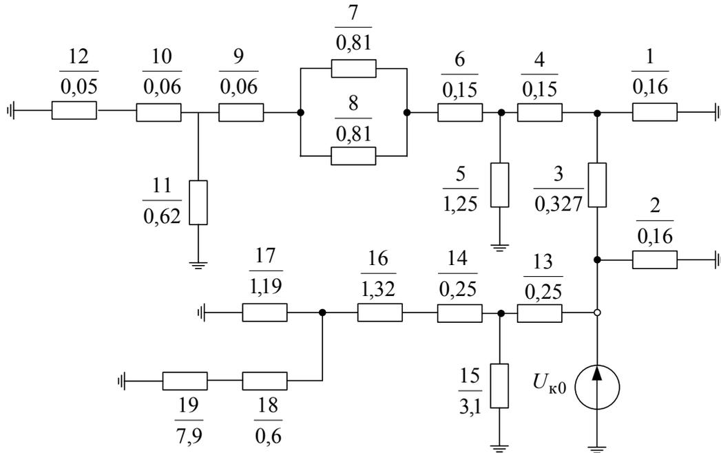
Рис. 9. Схема замещения нулевой последовательности
