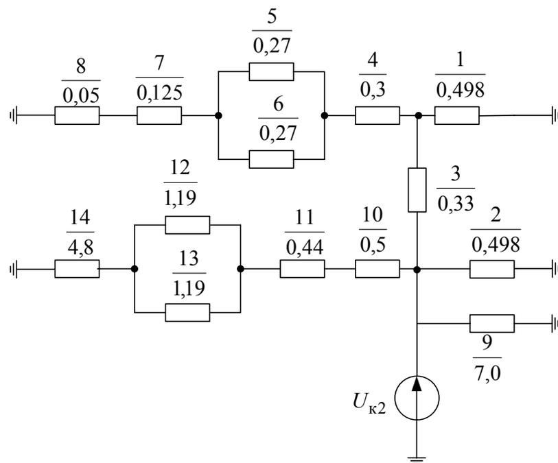
Рис. 8. Схема замещения обратной последовательности
