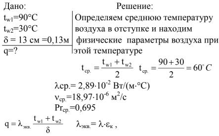
где  $\varepsilon_{\kappa}$  – коэффициент конвекции, зависящий от произведения Gr и Pr. Находим произведение Gr и Pr и коэффициента конвекции
