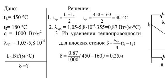
Ответ: толщина противопожарной стены бетона 0,28м.
