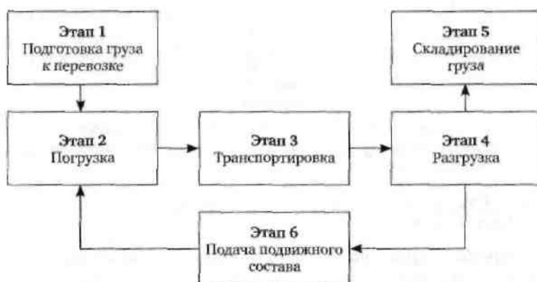
Рис.1. Технологическая схема процесса перевозки грузов одним видом транспорта
