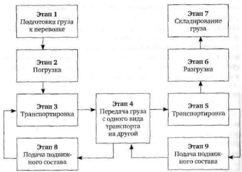
Рис.2. Технологическая схема процесса перевозки грузов различными видами транспорта
