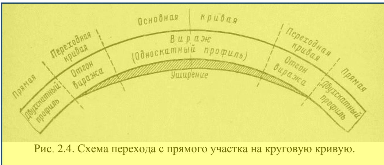
Рис. 2.4. Схема перехода с прямого участка на круговую кривую.
